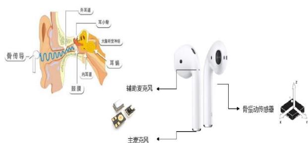
图 32: 骨传导传感器工作原理图
