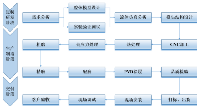
图表 17：涂布模头生产工艺流程图
