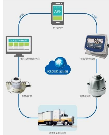
图 13：物联网称重系统架构
