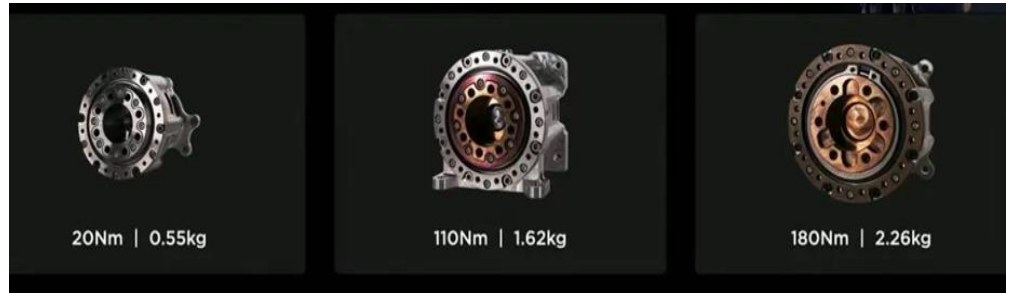
图33：特斯拉机器人旋转关节使用谐波减速器+伺服系统+传感器的集成化产品
