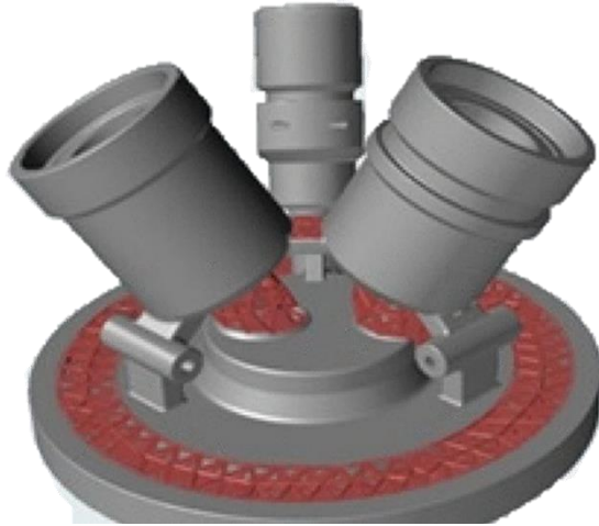
图 23：DMRL 团队拓扑优化燃料喷射器的 3D 模型
