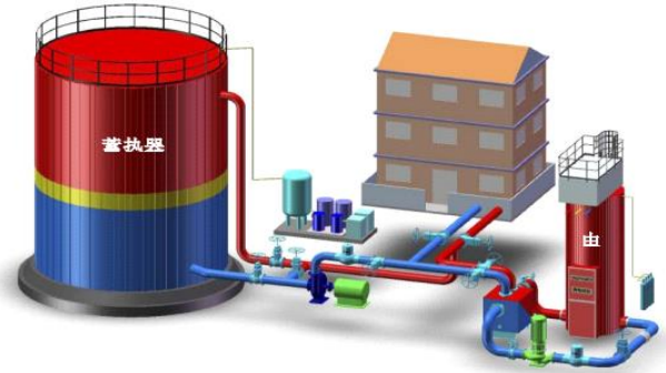
图 37：清洁能源消纳系统工艺图
