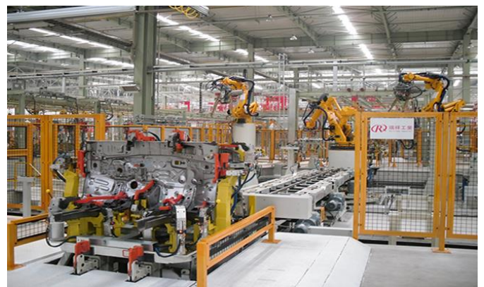
图28：汽车焊装自动化生产线
