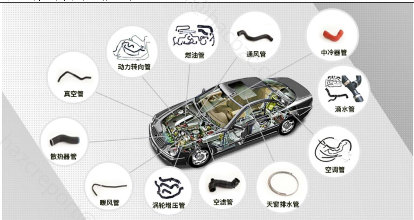
图 1、汽车胶管在整车上的应用情况
