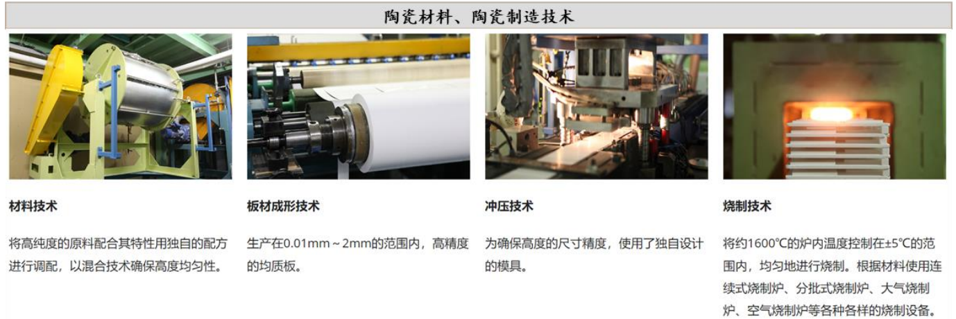
图 46：日本丸和核心陶瓷材料及陶瓷制造技术
