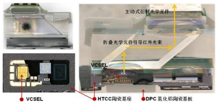
图 31: iPhone X 红外点阵投影器封装结构图
