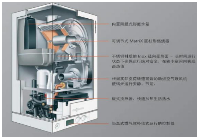
图20. 冷凝式壁挂炉示意图
