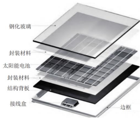
图 39：常规晶硅光伏组件结构示意图
