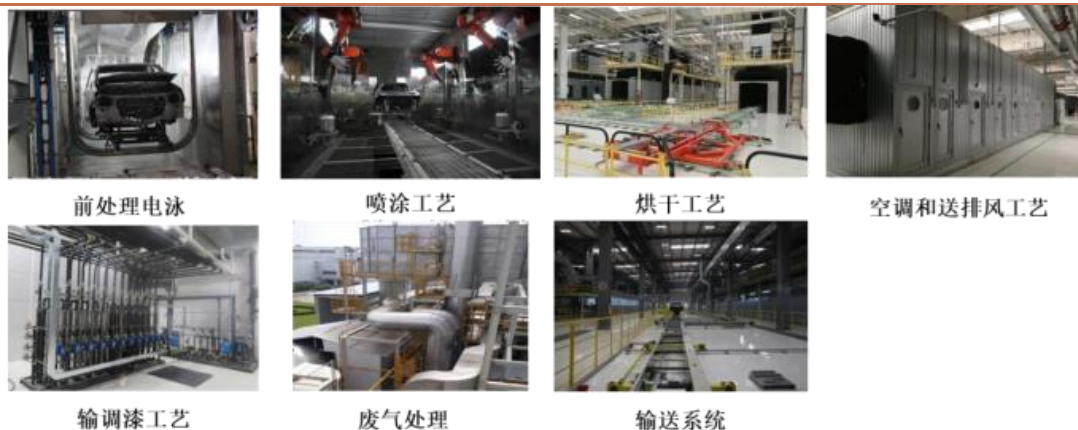
图 22: 常州海登可提供的汽车涂装工艺单元
