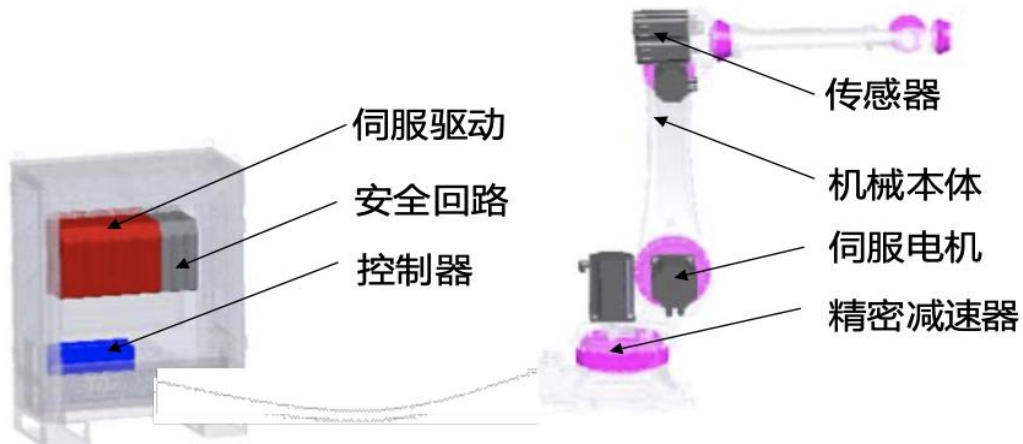
图表24： 典型工业机器人部件构成图
