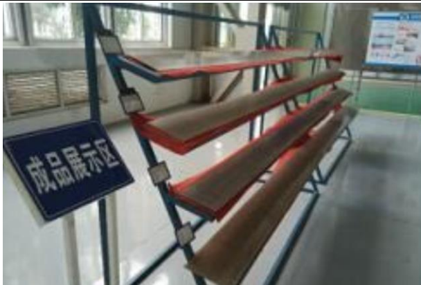
图32.应流生产的中子吸收板
