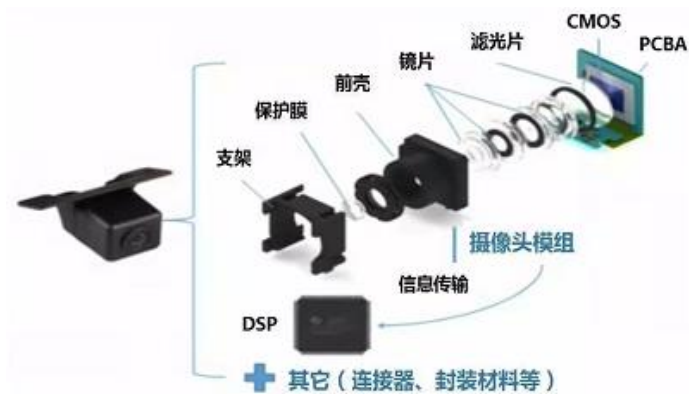
图表 14：车载摄像头组成结构
