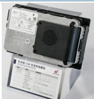
图表91：搭载南芯科技产品的安波福 15W 无线充电模块
