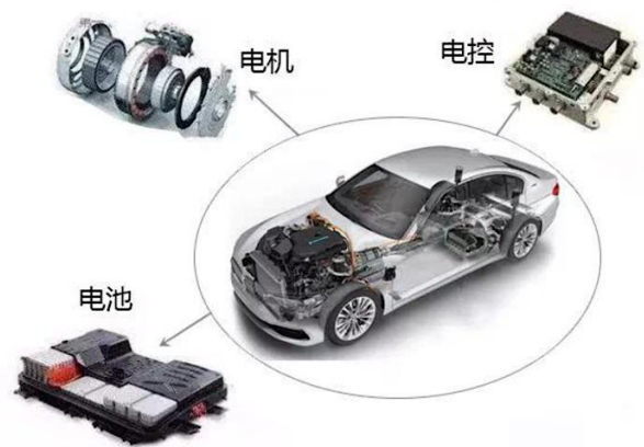
图表 42: 新能源汽车三电系统
