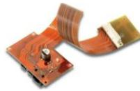
将 RPCB 和 FPC 层压，通过孔金属化工艺实现二者的电路连接
