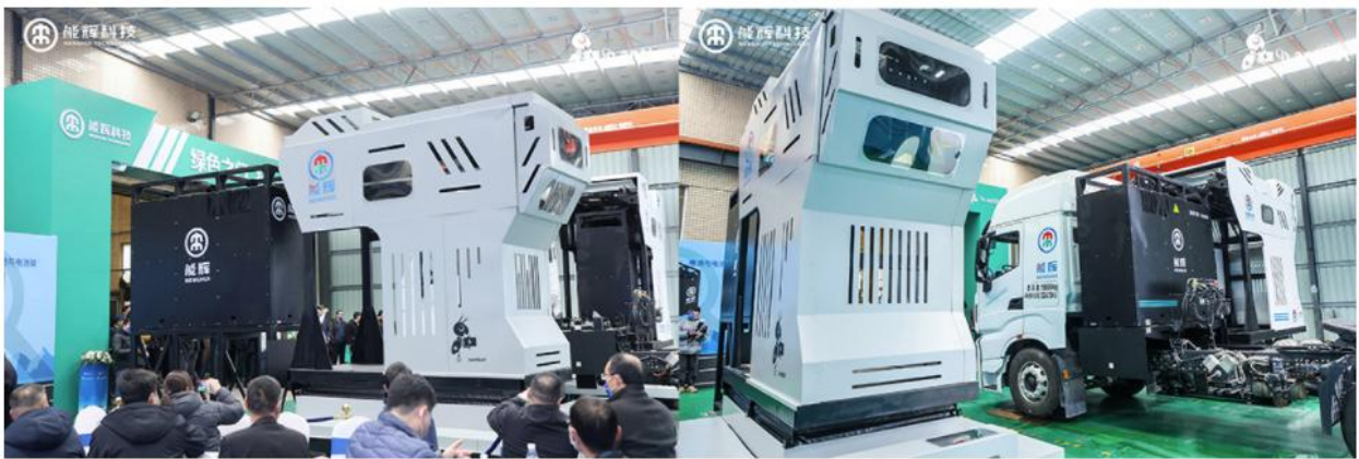
图表38：“小蚁”重卡换电机器人（AGV）为重卡换电
