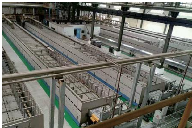
图 24：新天力正极材料烧结辊道窑（氮气气氛）
