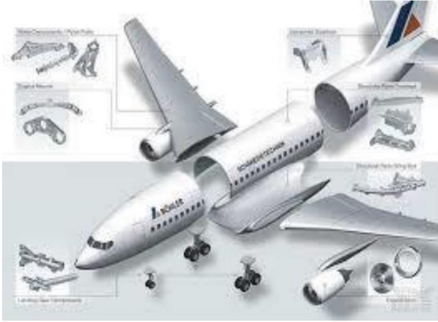
图 18：典型飞机结构分段
