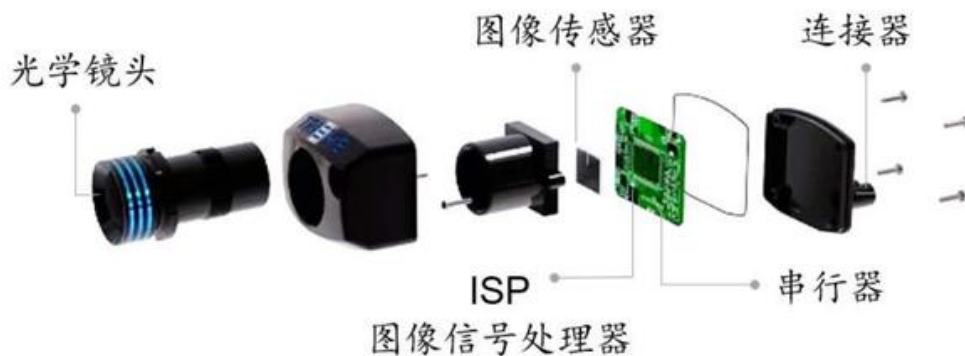
图表 50: 车载镜头结构示意图
