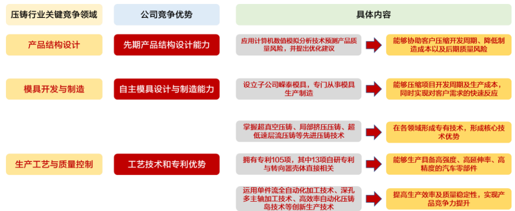
图 6：公司形成先期产品结构设计能力、自主模具设计与制造能力以及工艺技术和专利优势
