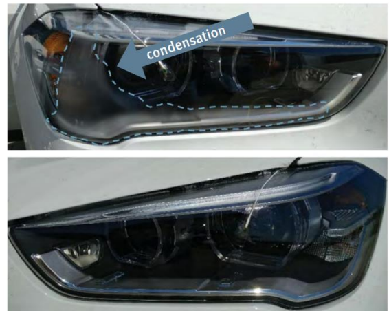
图表 27 增加 CMD 前 (上图) 后 (下图) 凝露解决情况
