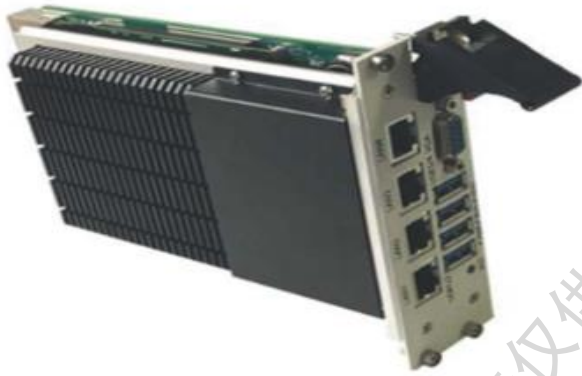
图表 38: 基于飞腾 CPU 设计的 3UCPCI 主板
