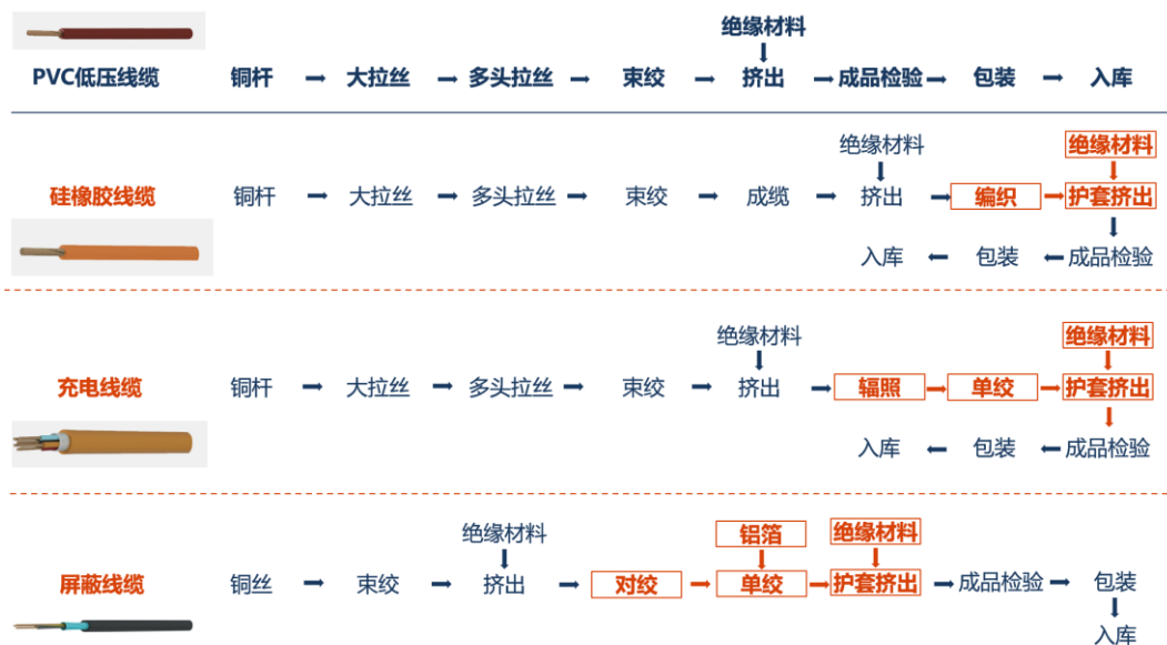
图表 31: 新能源电线与低压线缆制造流程差异
