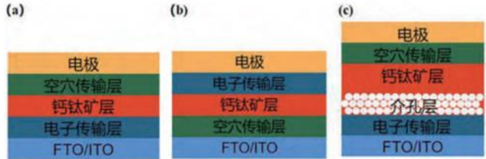
(a) n-i-p 结构平面 PSC; (b) p-i-n 结构平面 PSC; (c) 介孔 PSC
