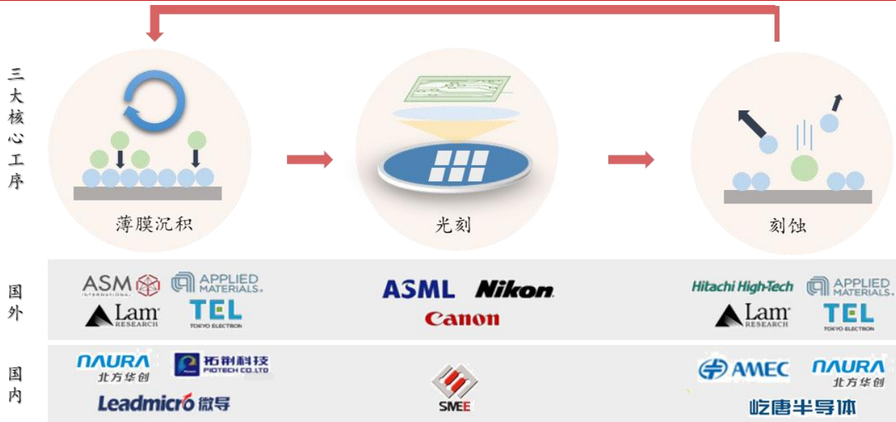
图30: 晶圆制造三大核心工艺及国内外主要设备公司
