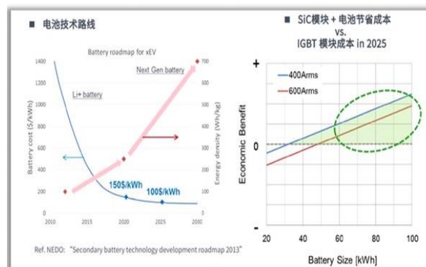
图 16: 逆变器中碳化硅和硅对成本的影响
