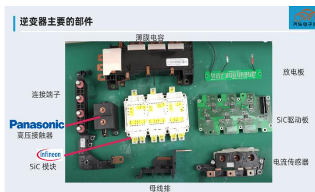
图 15: 现代 Ioniq 5 逆变器主要器件概览
