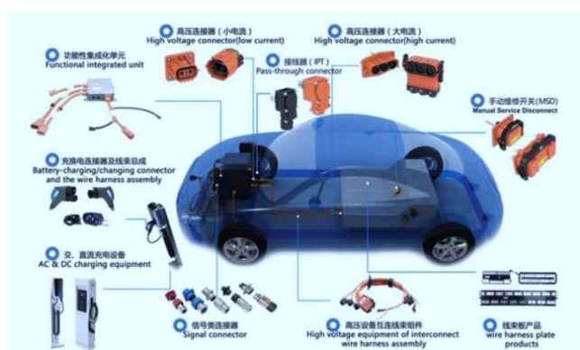
图27：汽车连接器结构示意图
