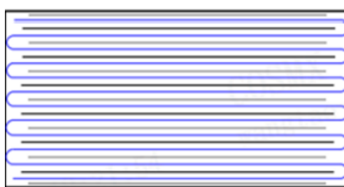
图 12：叠片技术路线软包电池结构示意图
