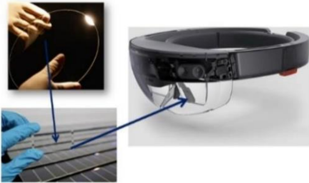
图 39：显示玻璃晶圆用于 AR 光波导
