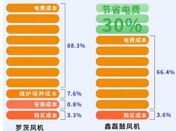
图 21：公司磁浮鼓风机与罗茨风机节能对比
