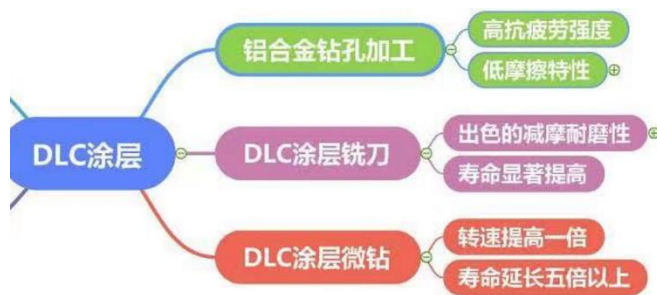
图23: 自主研发 DLC 涂层应用于钻针和铣刀
