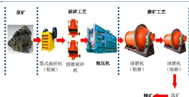
图表 29：采用辊压机的新型选矿工艺流程
