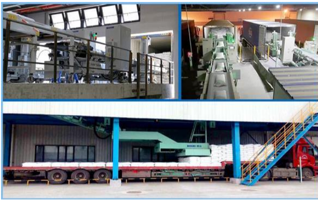
图35：全自动装车机大幅提升装车效率
