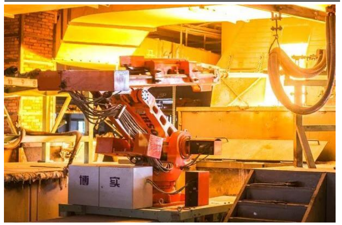
图30：出炉机器人可完成全部出炉环节
