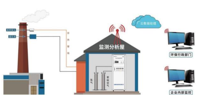
图 35：公司 VOCs 在线监测系统工作示意图
