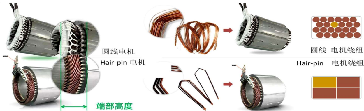
图 19 扁线电机与圆线电机
