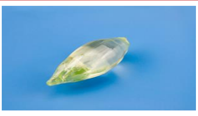
图表 22: 公司 TSAG 晶体示意图
