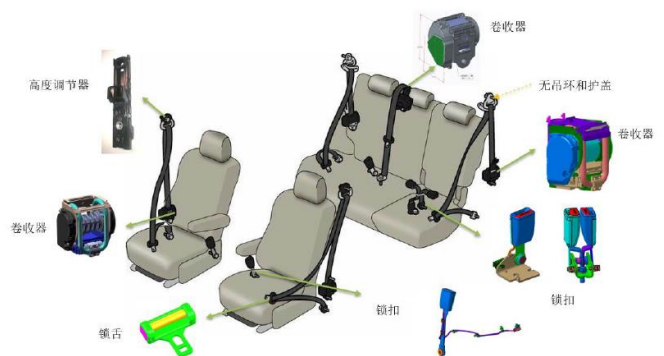
图17：安全带总成包含卷收器、高调器、锁扣等零部件
