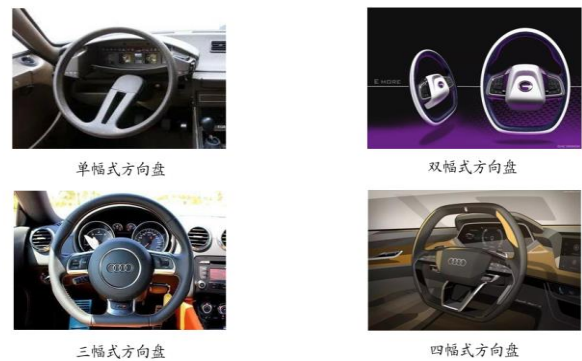
图24：依功能需求不同方向盘有多种设计
