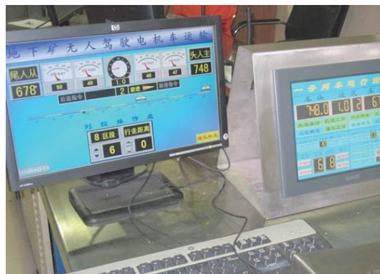
图表29：恩菲井下无人驾驶电机车全自动远程控制系統
