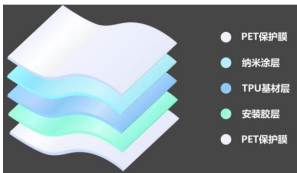
图表 20 隐形车衣结构图
