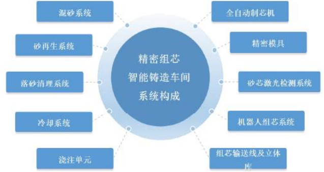
图 20：精密组芯智能铸造车间系统构成
