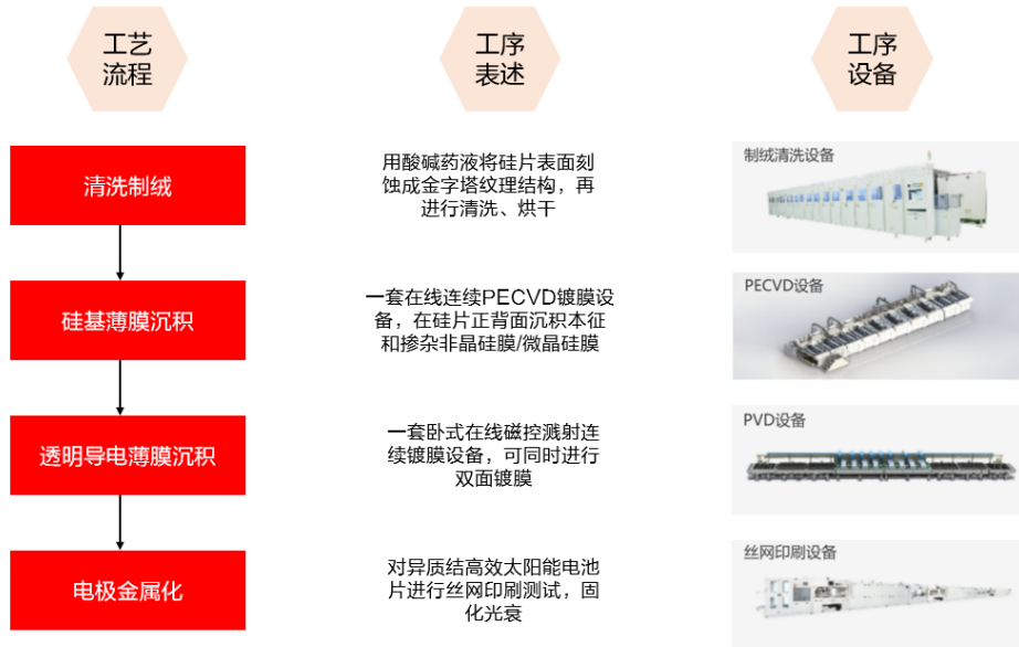
图 51: HJT 电池工艺流程
