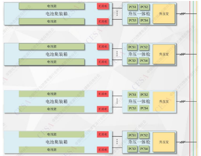
图36: 多组低压储能系统并联形成集合储能电站
