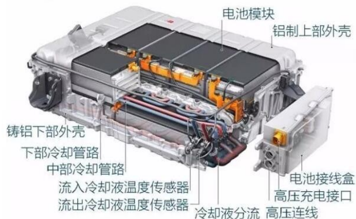
图10.奥迪 A3 sportback-etron 的动力电池包结构
