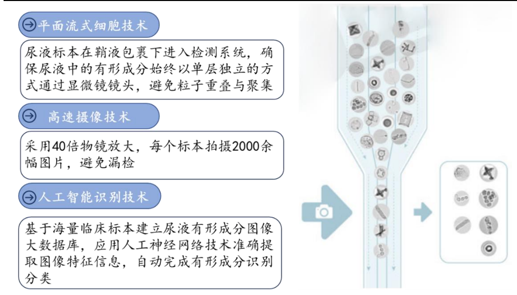
图 14：迪瑞使用的流式图像技术原理
