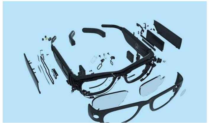
图 43: AR 眼镜拆解图
