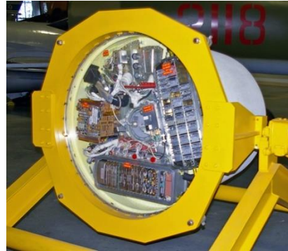
图表19: Autonetics D-37C 制导计算机
