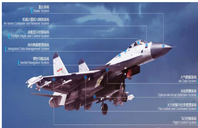
图表 26：嵌入式计算机应用于飞机各个分系统
