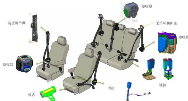
图 16：安全带总成结构图
