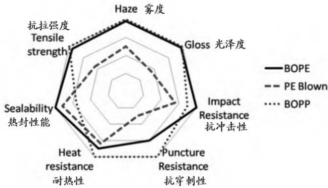
图表 56: BOPE 薄膜与吹塑 PE 膜和 BOPP 膜性能对比
