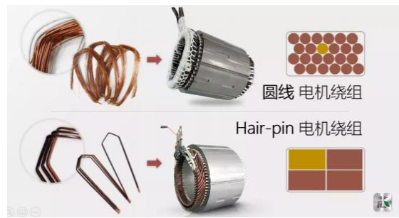
图 20 扁线电机的槽满率更高
