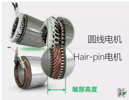
图 19 扁线电机的端部尺寸更短
