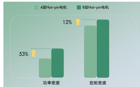
图 24 8 层绕组电机功率密度和扭矩密度更大
